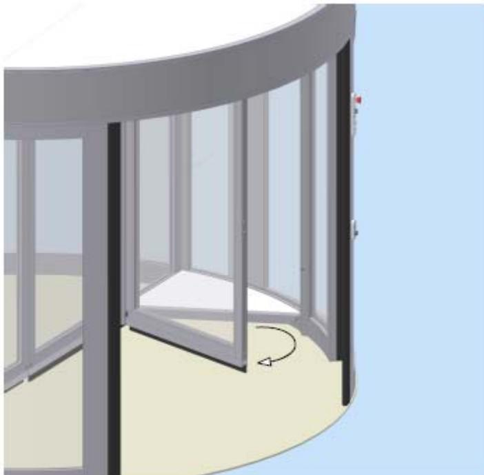
Для открытия нужно повернуть два замка против часовой стрелки при помощи шестигранника и открыть витрину на себя.
